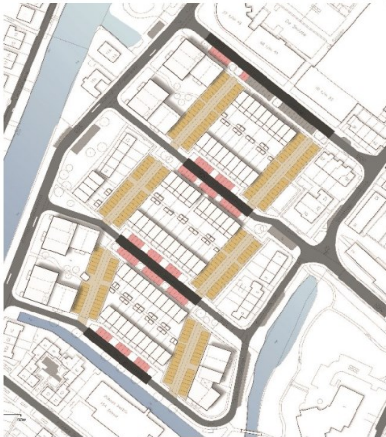
Parkeercoffers en haaks parkeren langs de straat
