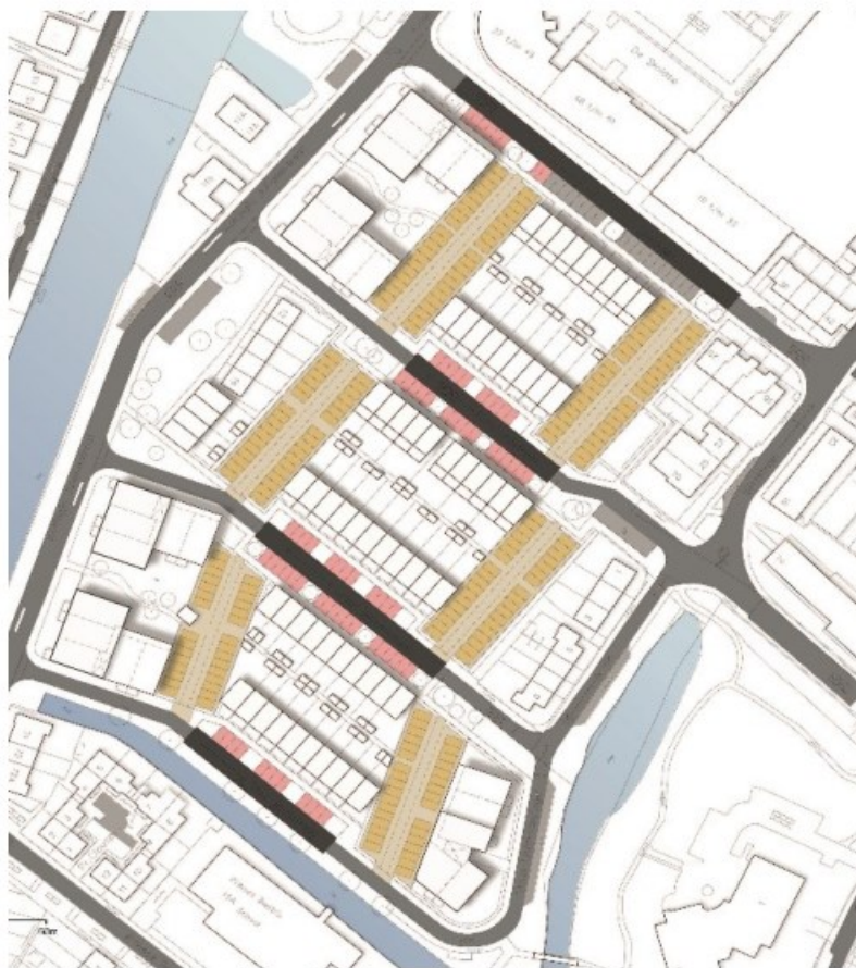
Parkeercoffers en haaks parkeren langs de straat
